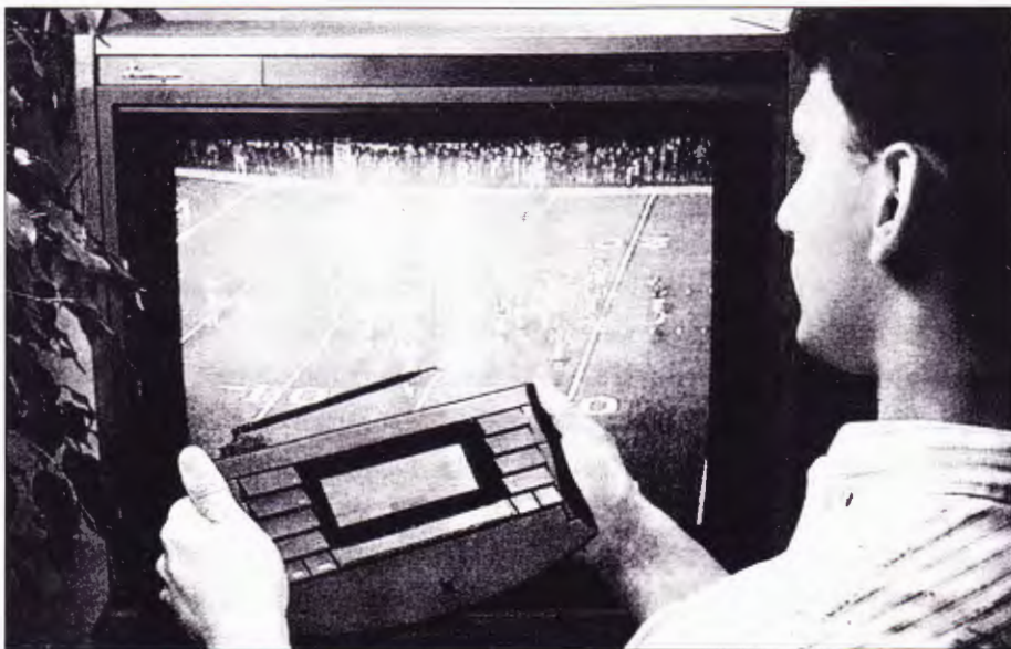
Här ses Home Customer Control Unit , TV-tittarens länk till Interactive Network (IN) . En LCD-skärm (240x60 pixels) ger realtidskontakt med sportprogram, frågesporter, spel o. likn.
